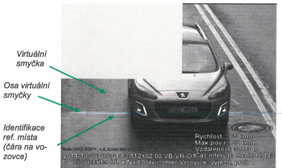
Obr. 9: Virtuální smyčka, ve které se provádí detekce RZ
